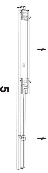
Montieren Sie die Linear Pro Leuchte in die Stromschiene.
