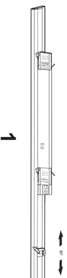
Schieben Sie die Befestigungssperre nach links oder rechts in die zweite Position, um eine Schienenverbindung zu vermeiden.
