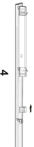
Schieben Sie den Kabelkasten in die Nähe des LED-Treibers. Ordnen Sie die Kabel und verbergen Sie sie, indem Sie die Kabelbox zurückschieben.
