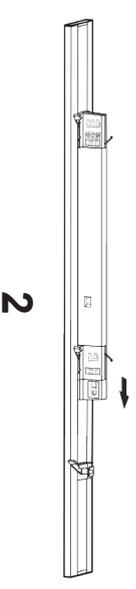
Legen Sie die Drähte im Kabelkasten frei, indem Sie ihn nach rechts schieben.
